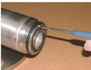
10. Смочить черные уплотнительные кольца чистой водой и протаскать к обоим концам кварцевой трубки. Прижать кольца соответствующим инструментом. Установите трубку симметрично между двумя концами.
