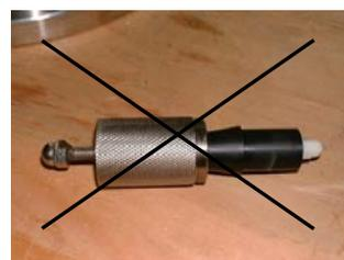
1. Демонтировать УФ-лампы обе гайки М-44 которыми закручена кварцевая трубка (см. 7.2.3.).
