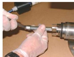
12. Прикрутить гайки M44 к корпусу со стороны противоположной сервисной. Использовать для этого специальный ключ.
