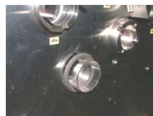
4. Прикрутить гильзу к плато УФ-камеры. Прикрутить гильзу не туго, во избежание спрессовки уплотнительных колец кварцевой трубки.
