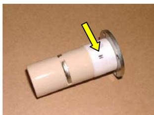
13. Установить патрон\* лампы. **Внимание:** патрон, расположенный со стороны противоположной сервисной, не имеет обозначения; патрон, расположенный с сервисной стороны, обозначен буквой **Н**. Убедиться в правильности!
